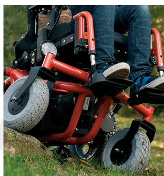
Voorzien van een stabilisatie as waardoor de vier wielen steeds op de grond blijven bij het rijden op oneffen terrein
